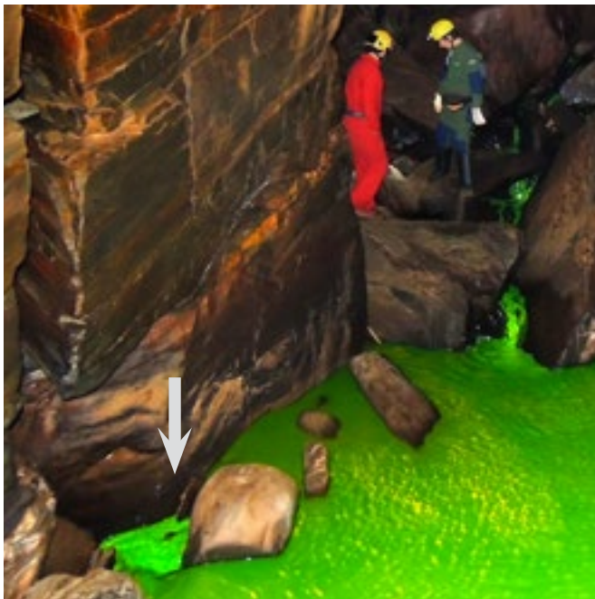
Passagem da fluoresceína no sumidouro na CAV-0001A, Morro do Pilar. FM Passage of fluorescein in the swallet of CAV-0001A, Morro do Pilar.
