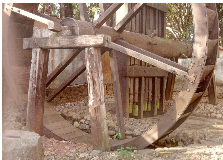
Figura 10 – Moinho para a trituração de minério, projeto de Eschwege, século XIX Fonte: MINERAÇÃO MORRO VELHO 1995 523 , p.31.
