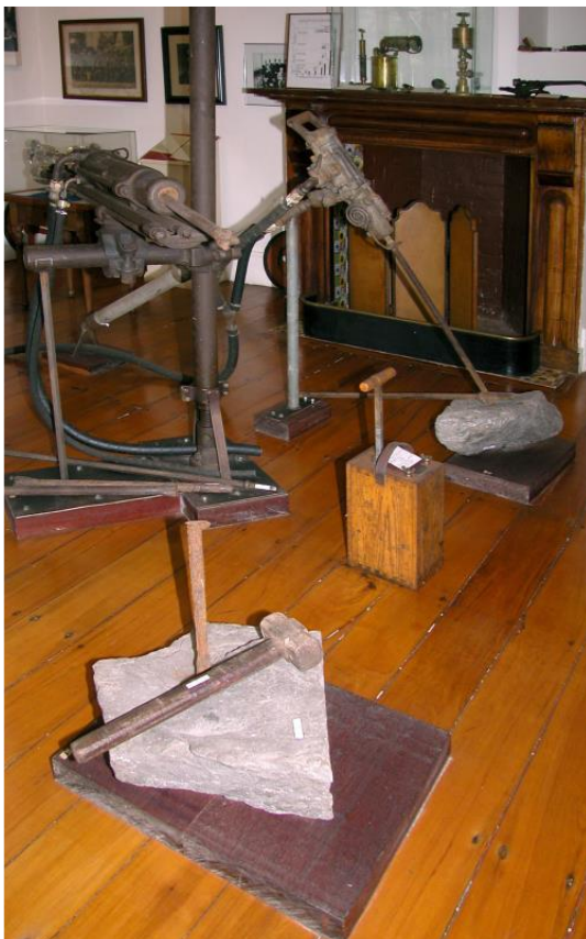
Figura 109 – Museu do Centro de Memória Morro Velho: perfuratrizes usadas para extração do minério aurífero/início do século XX Fonte: Centro de Memória Morro Velho, In DEOTTI, 2007.
