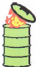
Extinção do fogo por abafamento
