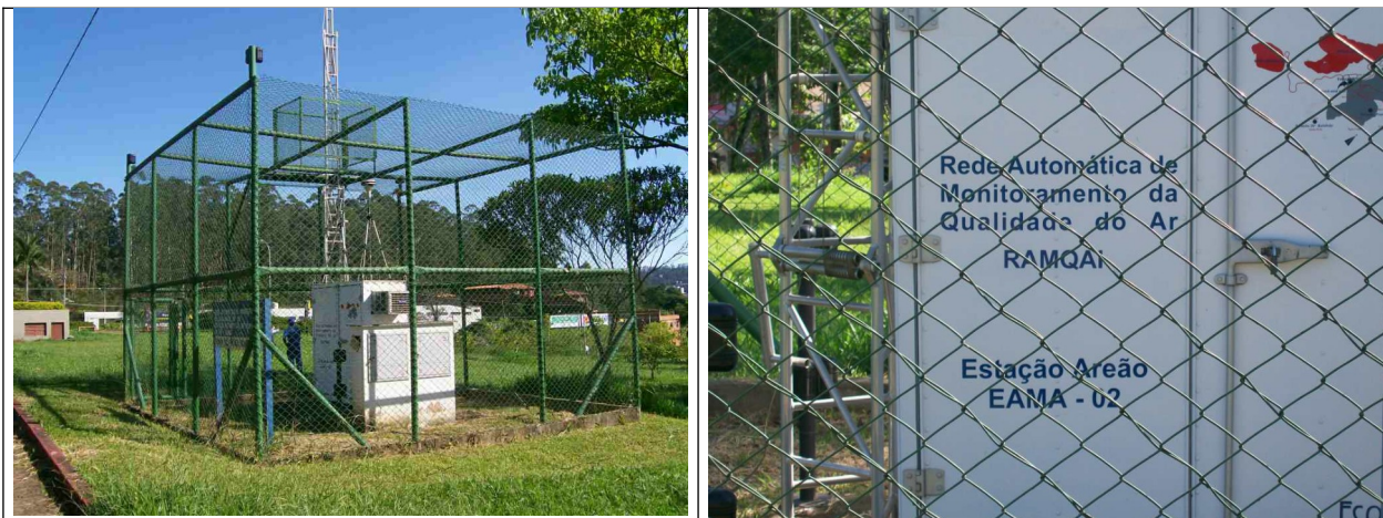
Figuras 31 e 32 – “Analisador de concentração de partículas totais em suspensão” instalado dentro da área da Praça.
