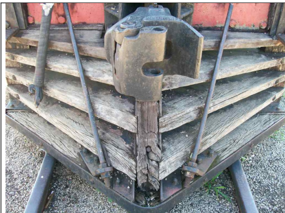
Figura 24 – Madeira deteriorada no bico da
