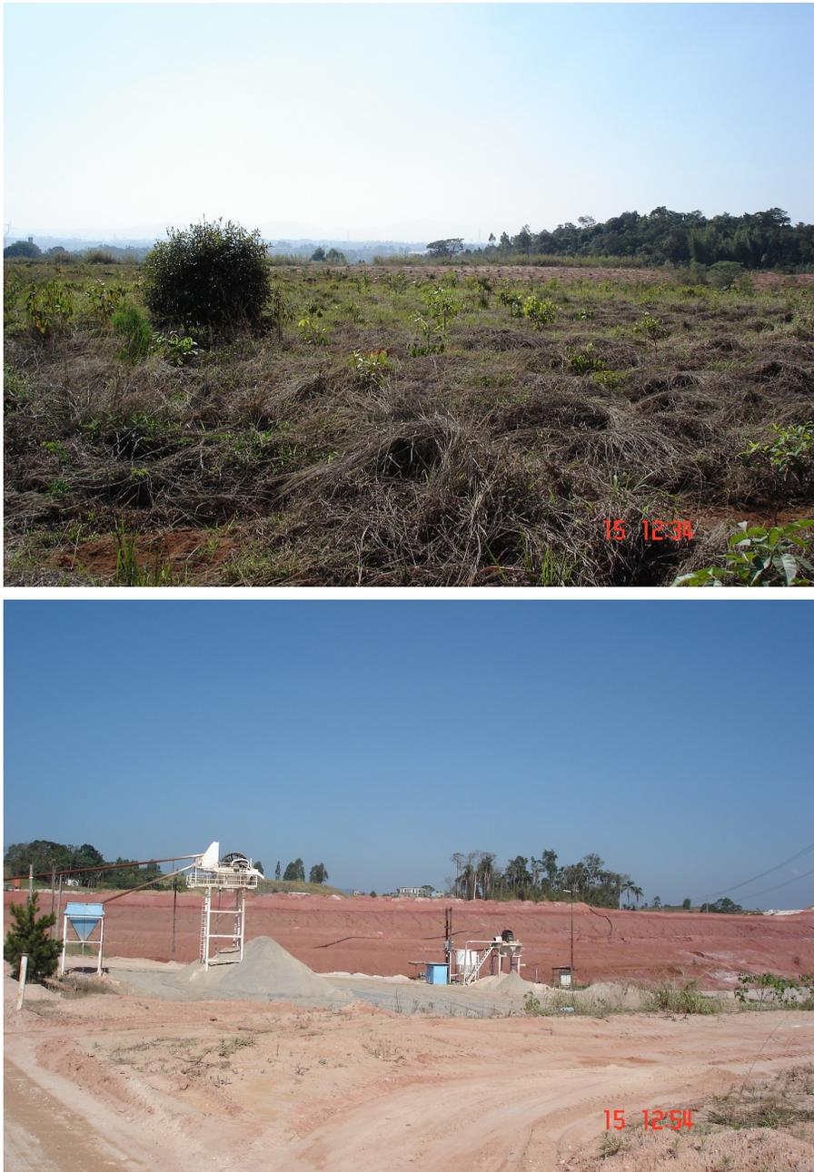
**FIGURA 16** | Acima, antigo depósito de estéril revegetado com gramíneas e espécies arbóreas nativas da região. Embaixo, área minerada em processo de preparação para reabilitação (Mineração Horii)
