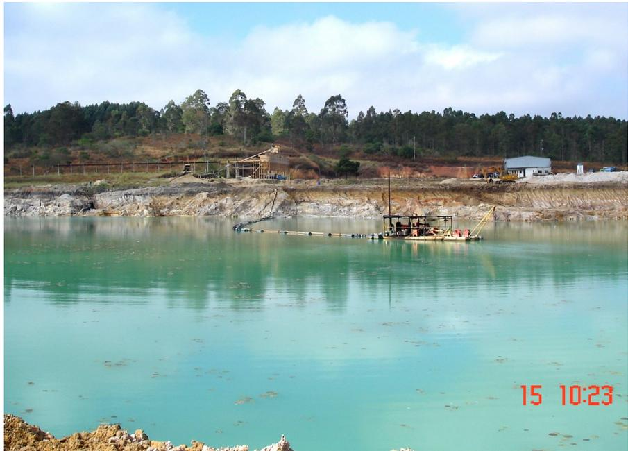
**FIGURA 14** | Extração de areia em cava alagada com emprego de draga de sucção, da VCN Mineração
