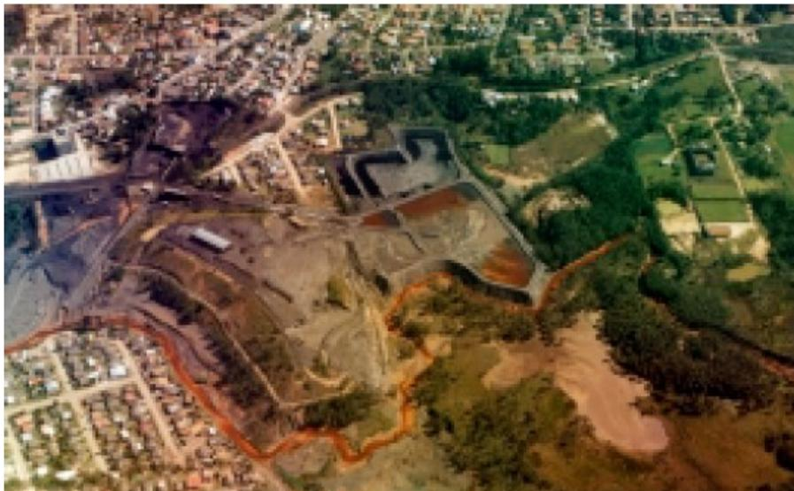
**FIGURA 18** | Vista aérea de uma instalação de beneficiamento de carvão e áreas adjacentes na bacia carbonífera de Santa Catarina. Observar drenagem ácida no curso d'água natural. Fonte: (CETEM, 2001)
