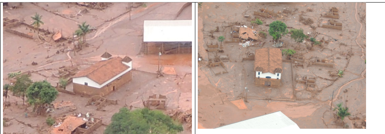
Figuras 05 e 06 – Imagens aéreas da edificação, após a ocorrência do rompimento da barragem de rejeitos de mineração.
