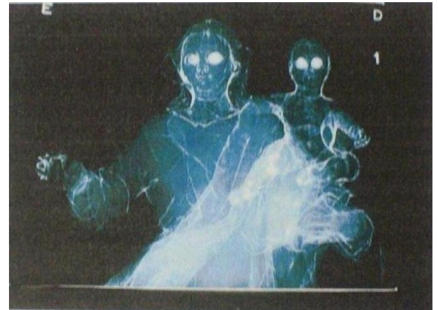
Figuras 7 e 8 - Nota-se que as partes divergentes da comparação anterior não aparecem, de forma nítida, no Raio “X”.
