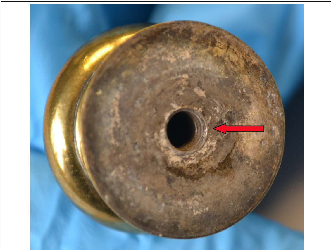
Figura 6 - Sulcos contínuos – em espiral – no orifício interno do arremate. Fonte: CPPC.
