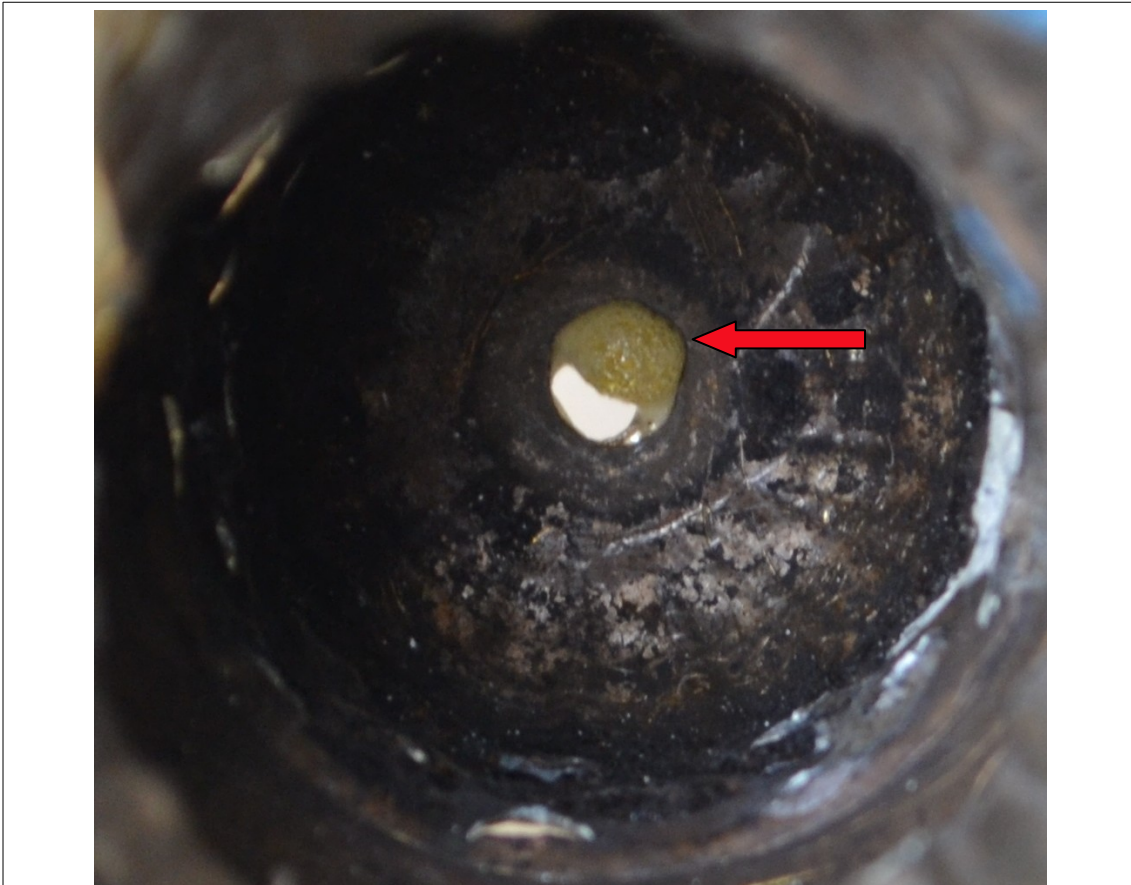
Figura 5 – Acúmulo de adesivo na parte interna da tampa. Fonte: CPPC.
